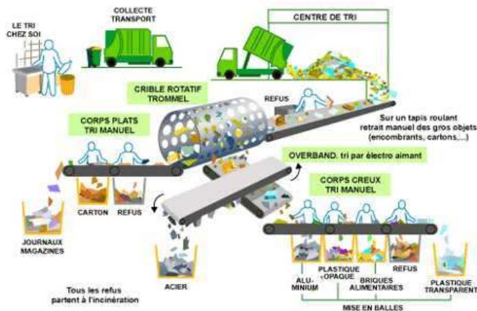
Les déchets sont amenés par camion puis chargés sur des tapis roulants pour être triés **par matière** par des **hommes** et par des **machines**.
